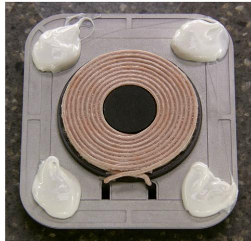
Figura D-2: Applicare Silicene 100% al trasmettitore
